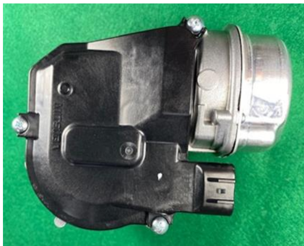
図 3. 本磁石を搭載した車載電装モータ(ワイパモータ)
