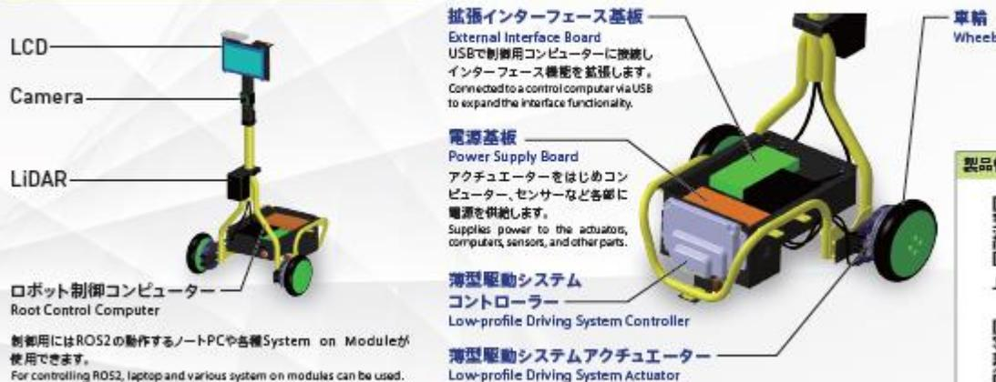
ロボット制御コンピューター
